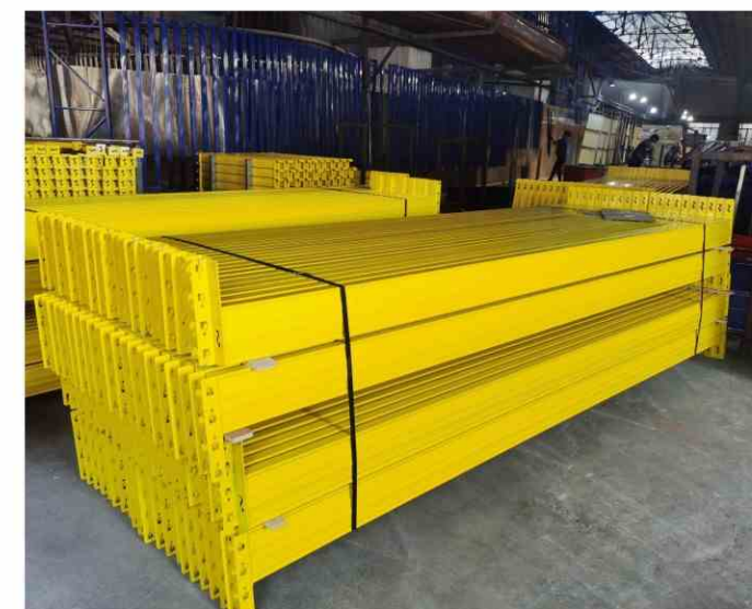
Box beam 横梁
