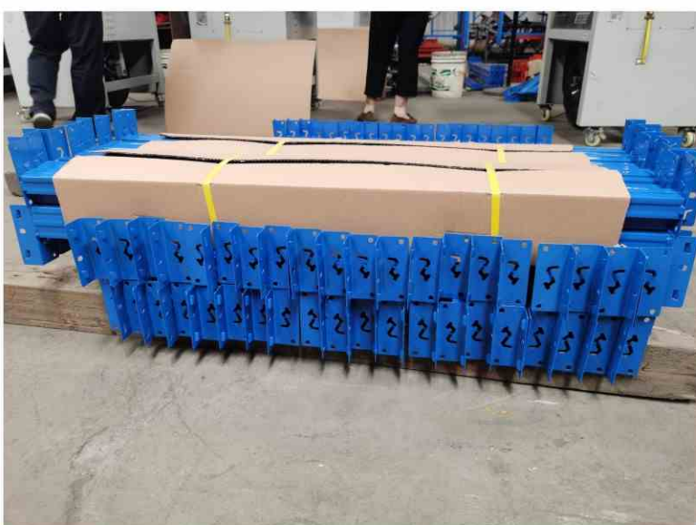
Box beam 横梁
