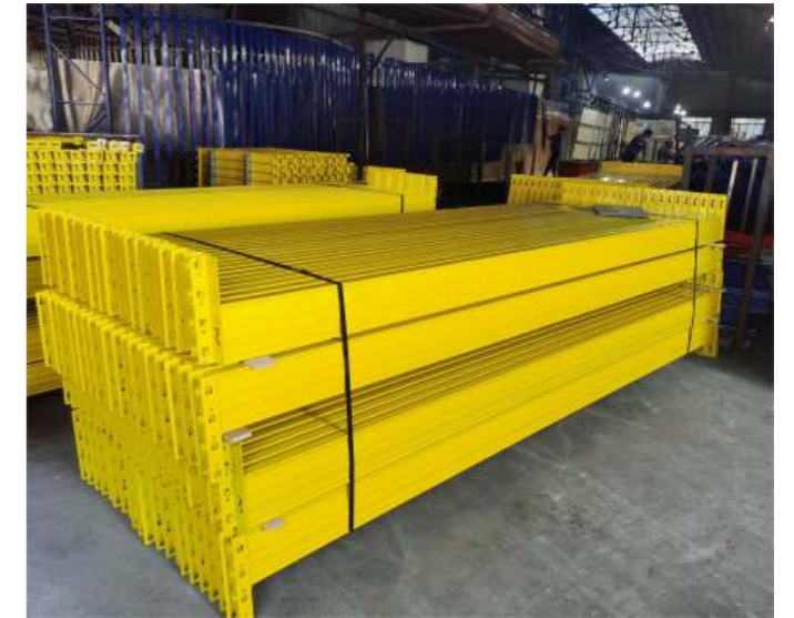
Box beam 横梁
