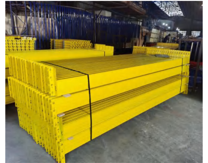
Box beam 横梁
